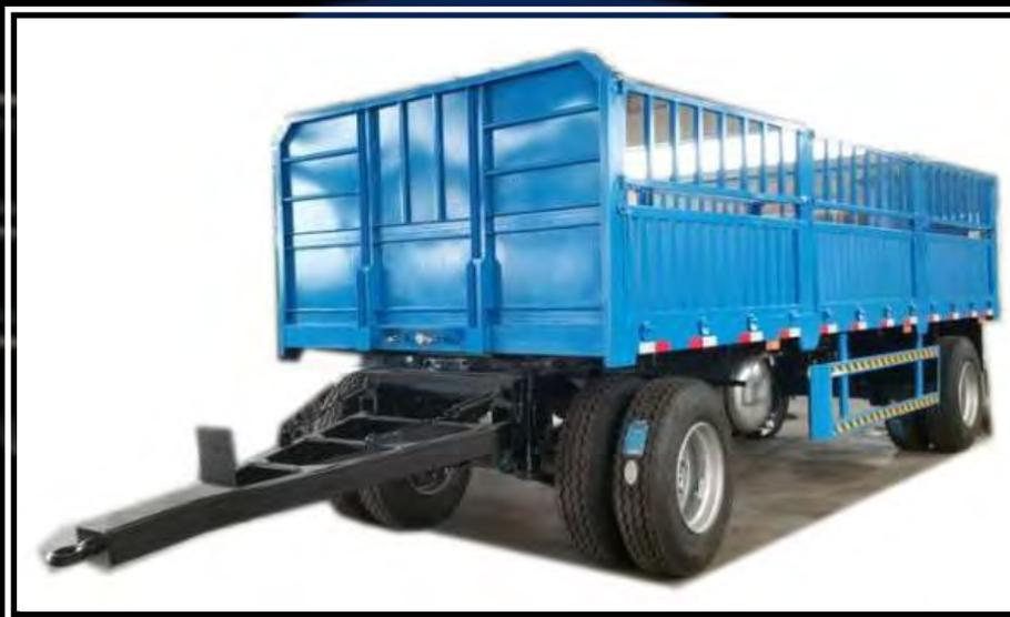
SU DISPOSITIVO DE ENGANCHE PUEDE DESPLAZARSE VERTICALMENTE, NO TRANSMITIENDO AL VEHÍCULO TRACTOR UNA CARGA SIGNIFICATIVA (INFERIOR A 100 kg).
