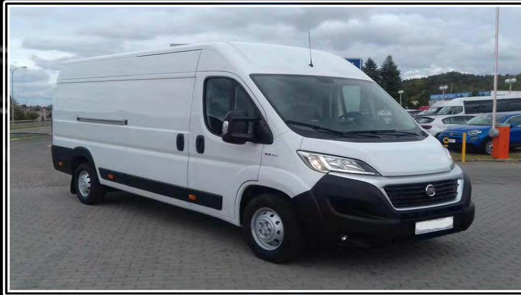
LA **CABINA** ESTÁ **INTEGRADA** EN EL RESTO DE LA CARROCERÍA Y PUEDE TENER UN MÁXIMO DE **9 PLAZAS**, INCLUIDA LA DEL CONDUCTOR.
