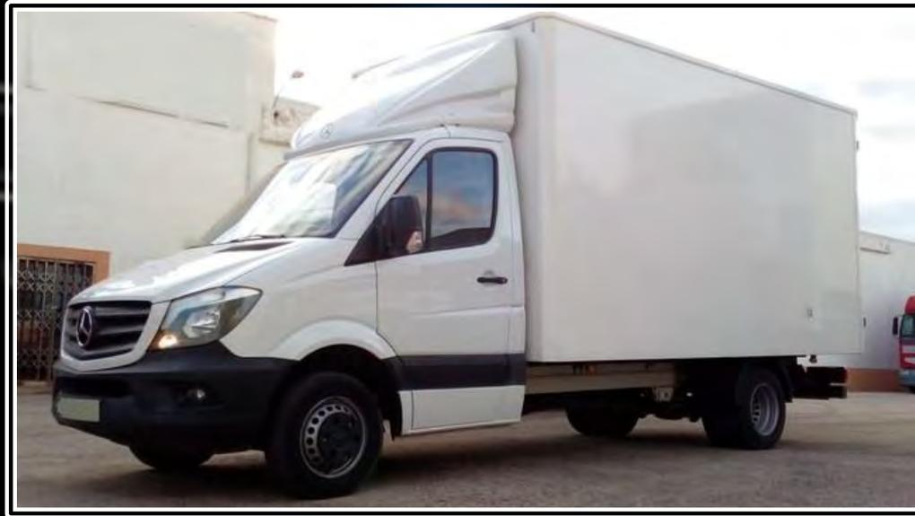
LA **CABINA NO** ESTÁ **INTEGRADA** EN EL RESTO DE LA CARROCERÍA Y PUEDE TENER UN MÁXIMO DE **9 PLAZAS**, INCLUIDA LA DEL CONDUCTOR.
