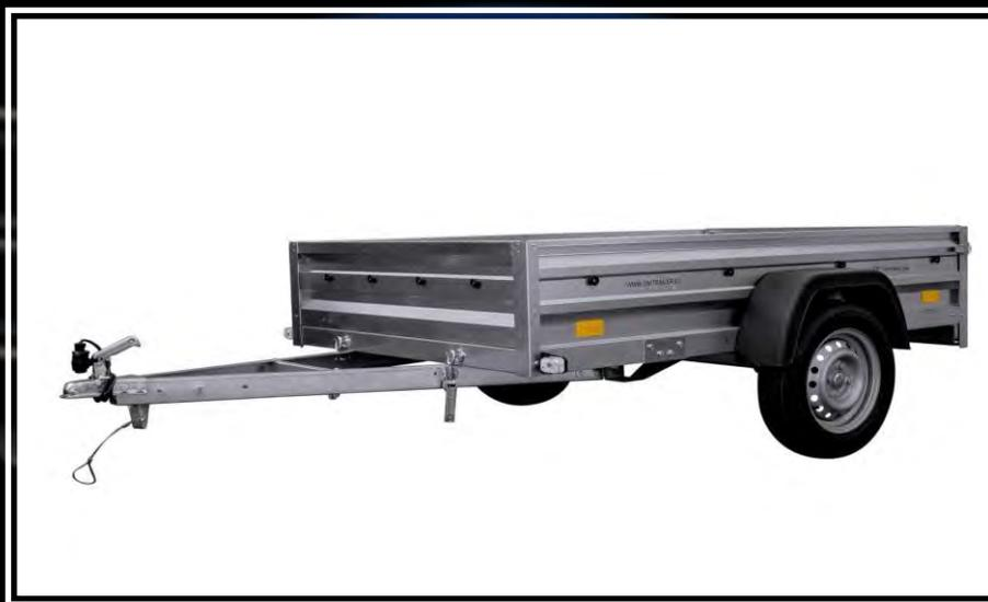
AL TENER EL EJE EN SU CENTRO DE GRAVEDAD, LE TRANSMITE AL VEHÍCULO TRACTOR UNA PEQUEÑA CARGA ESTÁTICA VERTICAL.
